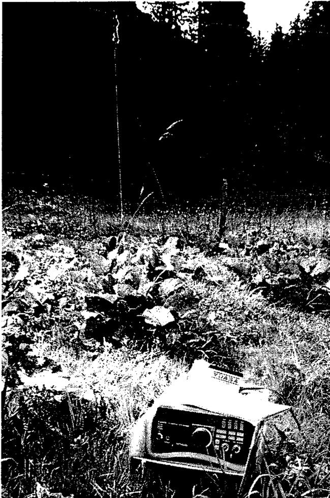
*Photo 5: Messpunkt Plätsch. Die Distanz zum Bakensender im Domgang ist 890m. Bei unseren Versuchen war dies die grösste überbrückte Distanz mit nur 10 Watt Sendeleistung bei der Bake.*
