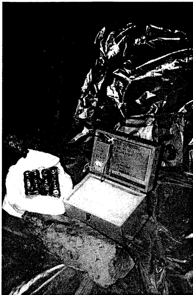
**Photo 3:** Der automatisch getastete 10 Watt-Bakensender im Domgang beim Auswechseln der 24 Volt-Speisung für die zweite Messreihe.
