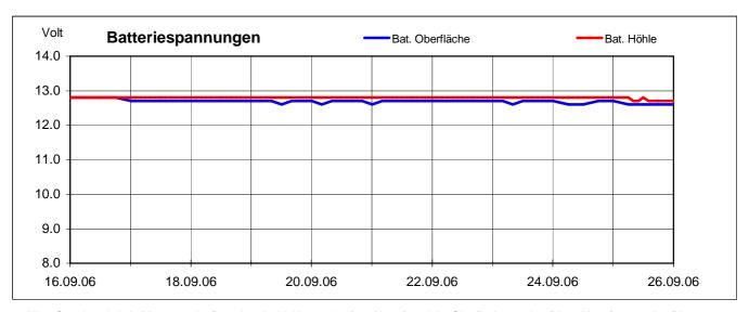
Alle 6 Stunden wird ein Messwert der Batterien der Höhlenstation (rote Kurve) und der Oberflächenstation (blaue Kurve) angezeigt. Die Elektronik arbeitet bis 9V fehlerfrei. Da es sich aber um Blei-Akkus handelt, sollten diese spätestens bei 10.5V ausgetauscht werden.
