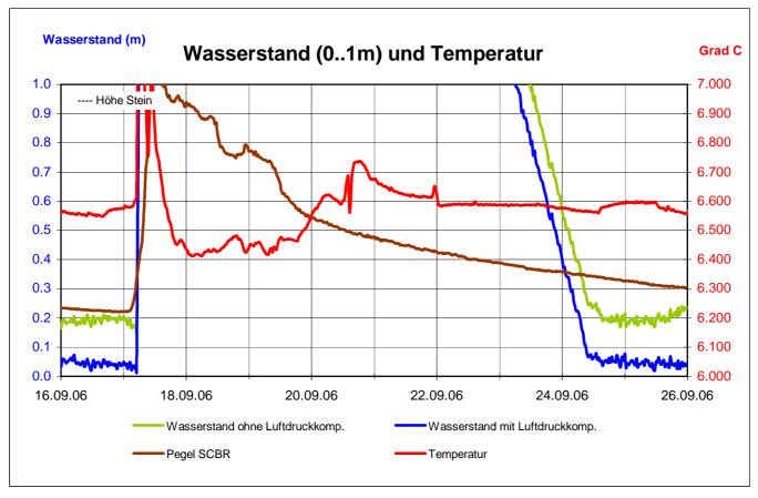
Die Station Keller misst den Druck und die Temperatur mit einer Auflösung von besser als 1/100 Grad C.
