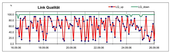
Die Daten werden alle 30 Minuten gemessen und alle 2h mit Cave-Link-Geräten zur Oberfläche übermittelt. Diese Modems Übermitteln die Daten in Blöcken welche von der Gegenstation quittiert werden müssen. Kommt der Block, oder eine Quittung, nicht oder fehlerhaft an, so wird repetiert bis eine korrekt Übermittlung möglich ist..
